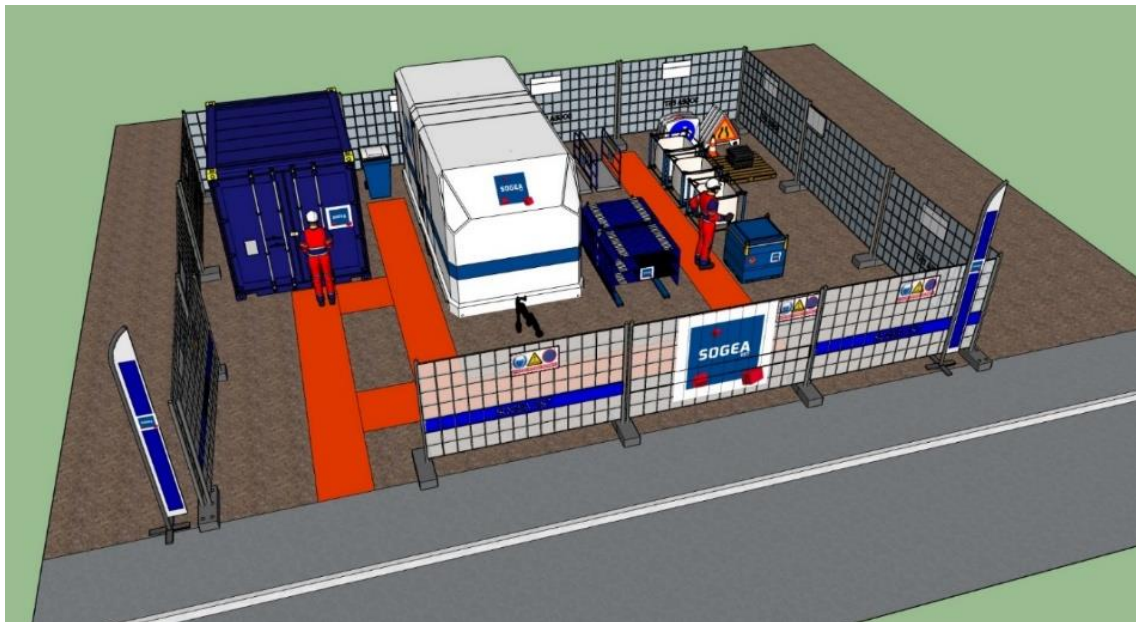
Implantation-type avec signalétique adéquate
